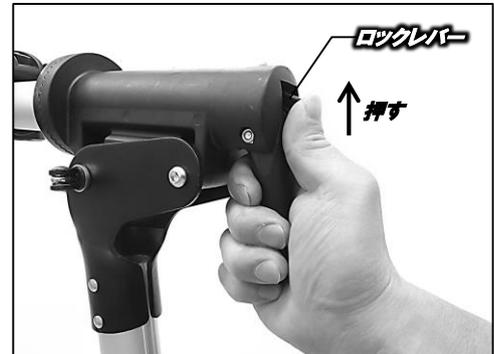
※ギアの噛み合わせ位置によって、角度を調整します。
