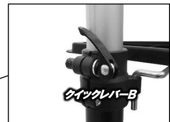
※クイックレバーBが緩いと車重によって下がってくるので確実に締め込んでください。
