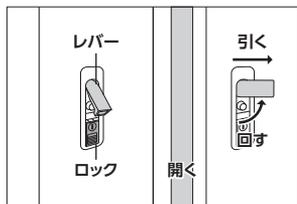
[開く] : カギを解錠し、ロックを下にスライドします。持ち上がったレバーを反時計回りに回しながら開きます。
