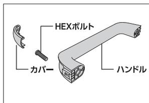
HEXボルトを左右締め込み、カバーを取り付けます。
