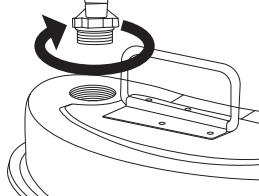
④ エア調整ねじを締め、少しづつ給油します。
