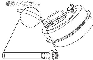
⑥ 給油後は、キャップとエア調整ネジを確実に締めてください。
