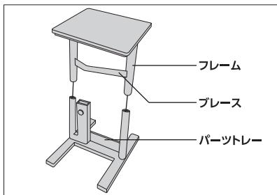
①ベースに、フレームを差し込みます。差し込む向きに注意してください。
