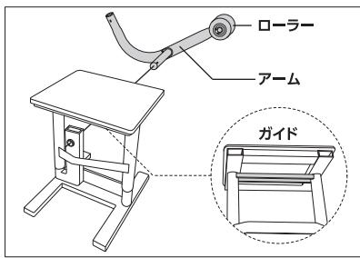
②アームを、取り付け穴に差し込みます。フレーム裏のガイドに、アームのローラーが収まるることを確認してください。
