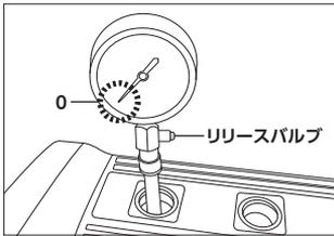
7) 測定後は、リリースバルブを押しゲージ内圧力を抜いてください。
