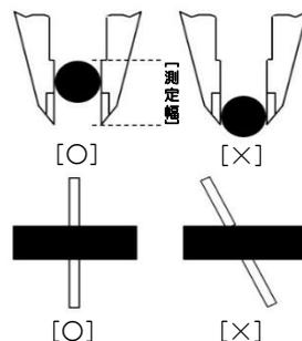
測定幅の中心から根元付近に、測定物を挟んで測定します。測定幅の先端付近で挟むと、測定誤差の原因となります。また、測定ジョーを斜めにあてることも、測定誤差の原因となります。
