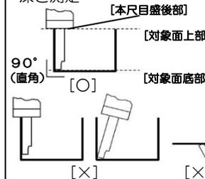
デプスバーを、対象面の側面に沿わせ、先端を底部に当て、本尺目盛後部を、対象面の上面に当てて測定します。デプスバーが傾いたり、浮いた状態では、誤差の原因となりますので、測定面に対して、90°になるようにしてください。
