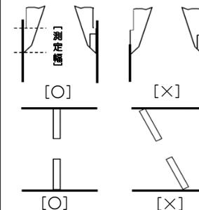
測定幅の中心から根元付近を、測定面にあてて、測定します。測定幅の先端付近で測定すると、測定誤差の原因となります。また、測定ジョーを斜めにあてることも、測定誤差の原因となります。
