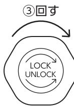
①本体末端のロックダイヤルを「UNLOCK」方向に回します。
