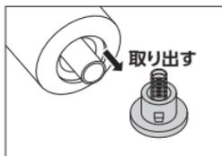
2. キャップを外し、古い電池を取り出し、新品電池と交換します。
