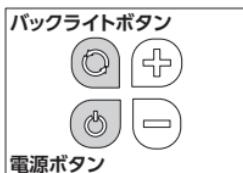
④ 電源ボタンを押し、電源を「ON」にします。
