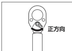
③ 対象物が正ネジの場合、正逆切替レバーが正方向(時計回り)であることを確認します。
