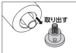
2. キャップを取り外し、古い電池を取り出し、新品電池と交換します。
