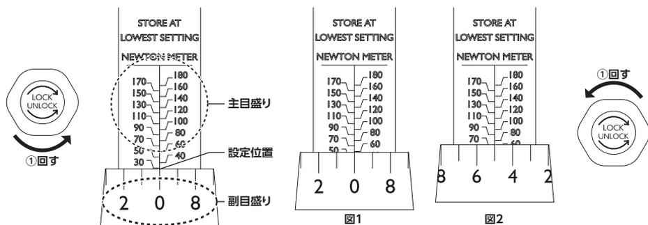
①本体末端のロックダイヤルを「UNLOCK」方向に回します。
