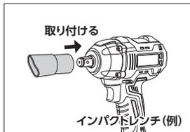
① 電動工具に本製品を取り付けます。
