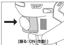
③ 電動工具をゆっくり慎重に操作し、ジャッキアップします。
