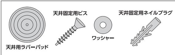
天井用ラバーパッドを、付属の天井固定用ビス、ワッシャーを使用し、任意の位置に取り付けます。
