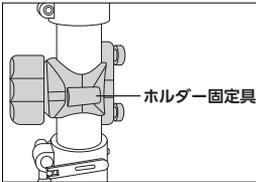
フック付きのホルダーベースプレートを、ポストのホルダー固定具に付属のHEXキーレンチ4mmを使用し、自転車が安定する角度で取り付けます。
