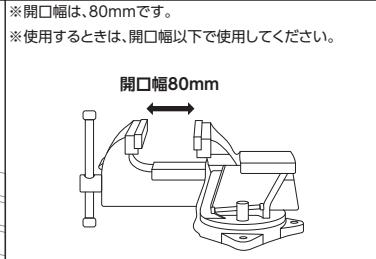
1. ポルト穴を利用し、強度のある作業台にしっかりと固定します。
