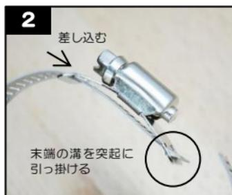
ネジ部前方の下にある穴に、バンドを通し、通した先にある突起に、バンド末端の溝を引っ掛けます。
