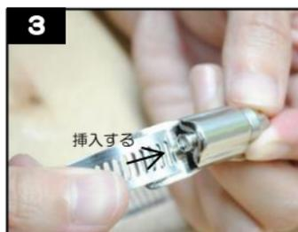
反対側のバンド末端を、ネジ部後方のネジ下の隙間に挿入し、ネジを時計回り方向に回します。バンドが引き込まれ、反対側にバンドが出れば完成です。
