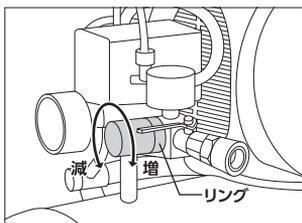
◎使用するエアツールによって、圧力を調節してください。
