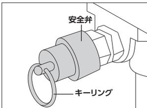
◎最高使用圧力以上になった場合、タンク内の圧力を逃がすための弁です。
