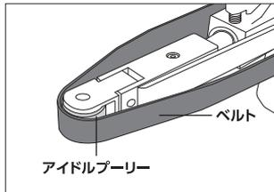
2. 摩耗したベルトを外し、新しいベルトと交換します。
