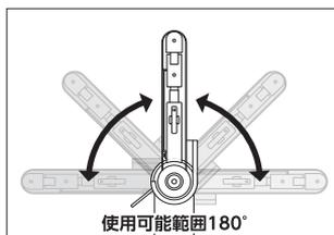
3. 角度ロックボルトを、しっかり締め付けます。
