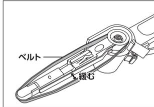
1. テンションバーを押し込み、ベルトのテンションを緩めます。テンションバーは、押し込むとテンションロックに引っ掛かり固定されます。
