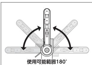
③角度ロックボルトを、しっかり締め付けます。
