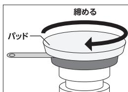
3. 取り付けるときは、レンチで押された状態で、パッドを時計回り方向に、しっかりと締め込みます。
