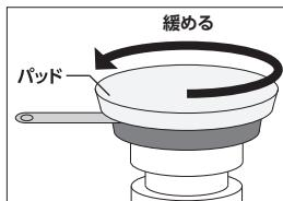
2. 取り外すときは、レンチで押された状態で、パッドを反時計回り方向に、緩めます。
