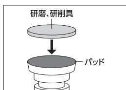
4. 面ファスナー式のパッドに、ペーパー、バフなどの研磨、研削具を取り付け、使用します。
