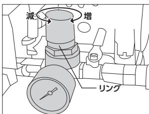
◎使用するエアツールによって、圧力を調節してください。
