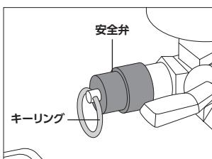
◎最高圧力以上になった場合、タンク内の圧力を逃がすための弁です。
