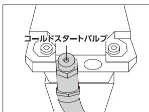
◎モーター起動後、約18秒間、バルブから圧縮空気を排出し、設定圧(約0.17MPa)になるとバルブを閉じます。
