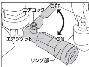
◎エアソケットは、圧縮空気を取り出すためのものであり、エアコックは流量を調節するための開閉弁です。
