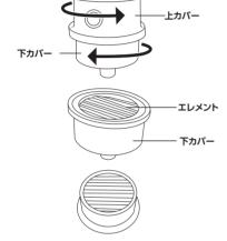
プローガンのノズルをエレメントに当てて エアプローしないでください。 エレメントが破損する恐れがあります。
