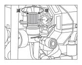
・ 使用するエアツールに合わせて、レギュレーターで圧力値を調節して ください。
