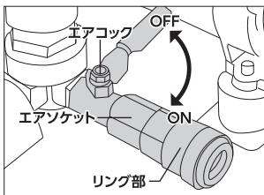
◎エアソケットは、圧縮空気を取り出すためのものであり、エアcockは流量を調節するための開閉弁です。
