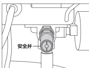
◎最高圧力以上になった場合、タンク内の圧力を逃がすための弁です。
