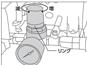
◎使用するエアツールによって、タンク内の圧力値を調節してください。
