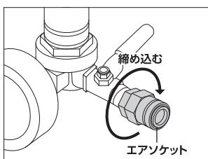
②エアソケットを、19mmレンチを使用し、締め込んで取り付けます。
