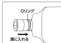
①Oリングを溝からずらし、アンビルの穴とソケットの
