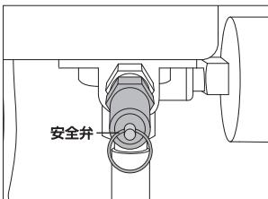
●最高圧力以上になった場合にタンク内の圧力を逃がすための弁です。
