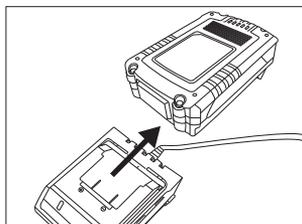
5. 充電完了後は、バッテリーを取り外し、電源プラグをコンセントより抜く。
