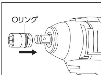
①Oリングを溝からずらし、アンビルの穴とソケットの穴が合うようにしてソケットを差し込む。
