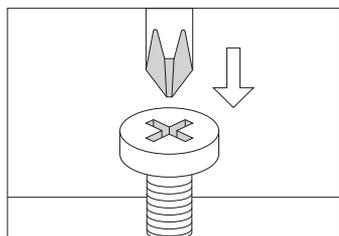
④ビットをネジ頭部の溝にきちんとあて、トリガーを引きながらビットがネジ頭部の溝から外れない程度で押し付けてください。
