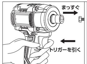
④ボルトナットに対して工具本体をまっすぐにしてトリガーを引く。
