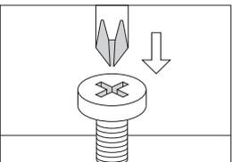
⑤ビットをネジ頭部の溝にきちんとあて、トリガーを握りながらビットがネジ頭部の溝から外れない程度で力で押し付けます。
