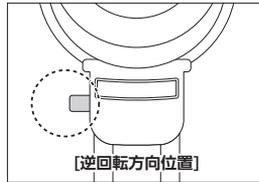
②正逆切替スイッチで、回転方向を切り替えます。
