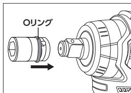
①Oリングを溝からずらし、アンビルの穴とソケットの穴が合うようにしてソケットを差し込みます。
