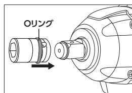
①○リングを溝からずらし、アンビルの穴とソケットの穴が合うようにしてソケットを差し込みます。
