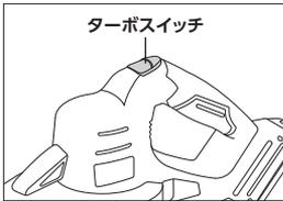
作業に応じてターボスイッチを押し、風量を上げます。
