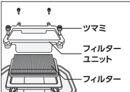
④フィルターを水洗いし、風通しの良い場所で十分乾燥させます。
