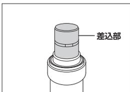
①油圧ラムのシリンダーに付いているキャップを取り外します。
