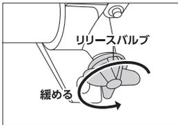
⑦油圧ラムのシリンダーが伸びることを確認し、リリースバルブを反時計回り方向に1回転回し、シリンダーを縮めます。
