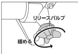
①リリースバルブを反時計回り方向に1回転回し、リリースバルブを緩めます。
