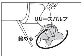
⑤リリースバルブを時計回り方向に回し、最後までしっかり締め込みます。
