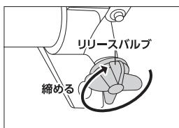
⑤ リリースバルブを時計回り方向に回し、最後までしっかりと締め込みます。
