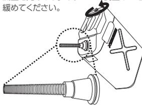
⑥ 給油後は、キャップとエア調整ネジを確実に締めてください。
