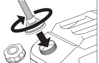
④ エア調整ねじを締め、少しずつ給油します。
