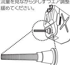
⑥ 給油後は、キャップとエア調整ネジを確実に締めてください。
