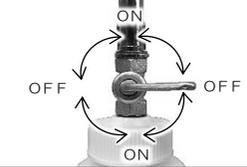
流量調節コックは、360°回転しますが、90°の範囲で、ONとOFFを調節できます。また、コックは微調節できるので、ブレーキフルードの流す量を調節可能です。
