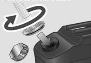
④エア調整ネジを締め、少しづつ給油します。
