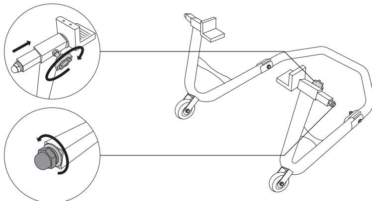
④メインフレームにプロテクターを取り付けます。
