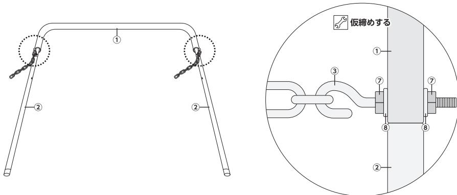
④フックボルト、⑦M8ナット、⑧M8ワッシャーを使用し、仮締めします。
