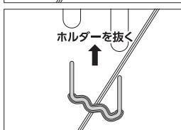
⑤ プラスチックが冷えて固まつたら、ホルダーを補修ピンから抜きます。
