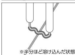
④ 補修ピンが、半分ほど溶け込んだら、動かさず電源ボタンを放します。
