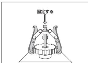
2. JAWアームが垂直でセンター・ブロックに対して左右均等であることを確認し、JAWアームのボルト、ナットでプレートをしっかりと固定してください。
