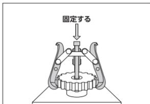
2. JAWアームが垂直でセンターブロックに対して左右均等であることを確認し、JAWアームのボルト、ナットでプレートをしっかり固定してください。
