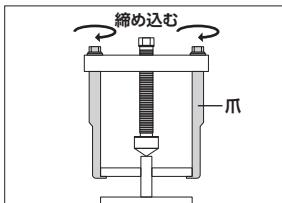
2. 固定ボルトを締め込み、爪を固定します。
