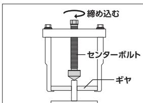
3. センターボルトをゆっくり慎重に締め込み、ギヤを取り外します。
