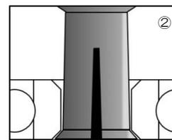
②アタッチメントにテーパボルトを挿入。レンチを使用し、しっかり締め込みます。この際、必ずアタッチメントがベアリングに対し、垂直であることを確認。
