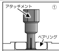
①ベアリング内径に合うアタッチメントを選択。奥まで差し込み、軽く引き上げ、アタッチメント先端の爪部がベアリングの内側に掛かることを確認。掛からない場合は、ベアリング内径を再確認後、アタッチメントを選択し直してください。
