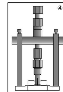
③本体を平面にセットします。この際、ベアリングに干渉しないよう脚を左右均等に広げ、ボルトでしっかり固定し、センターボルトをテーパボルトに挿入します。
