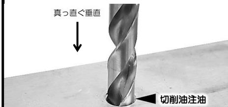
損傷したねじ山をドリルで取り除き、切りくずをキレイに除去してください。袋穴の場合は、推奨されている下穴深さ以上に開けます。
