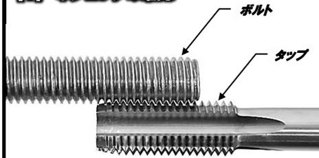
タップにボルトを当て、ねじピッチを確認します。ピッチが合わない場合は、使用しないでください。
