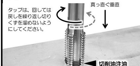
加工した下穴にタップを立てます。切りくずはキレイに除去してください。
