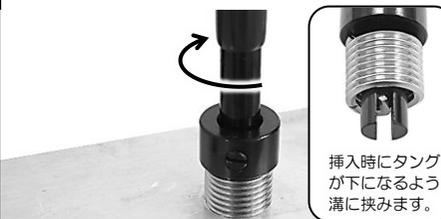
1/4~3/4回転までは軽く押さえながら回し、スクリーコイルの端末が、タップ開始部より1/2~3/4山程度沈み込むのが適当な挿入深さです。
