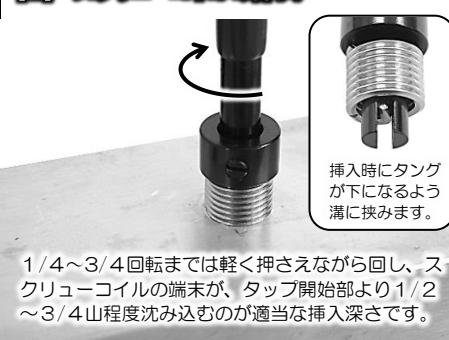
1/4～3/4回転までは軽く押さえながら回し、スクリューコイルの端末が、タップ開始部より1/2～3/4山程度沈み込むのが適当な挿入深さです。
