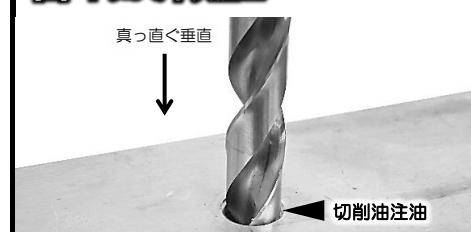
損傷したねじ山をドリルで取り除き、切りくずをキレイに除去してください。袋穴の場合は、推奨されている下穴深さ以上に開けます。
