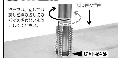
加工した下穴にタップを立てます。切りくずはキレイに除去してください。
