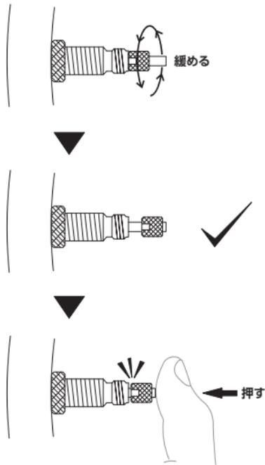
※シーラントを使用している場合、エアを抜くときにシーラントが吹きこぼれる恐れがあるので、仏式バルブが水平または下向きになる位置にして作業してください。
